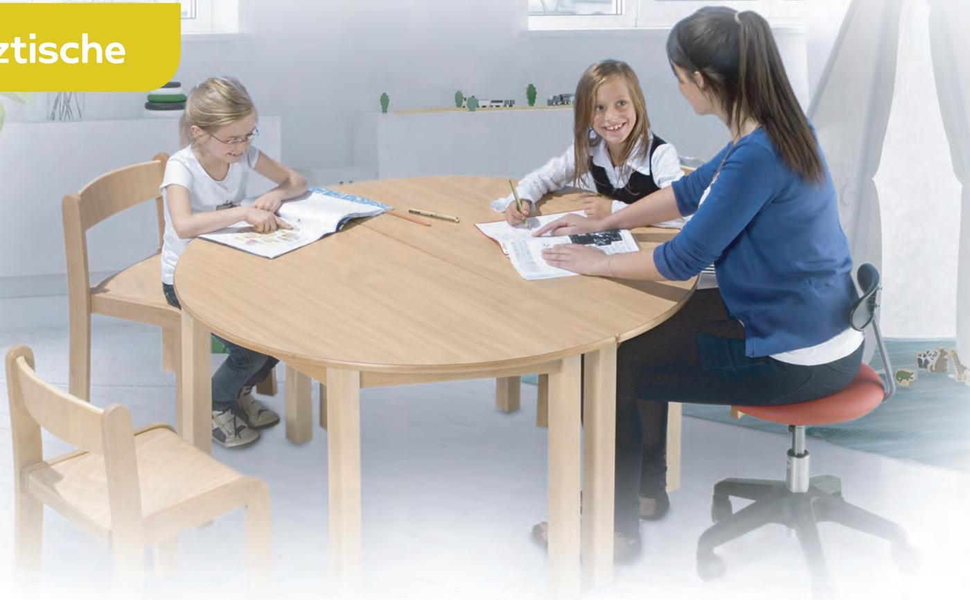
Die Beine und Zarge dieser Tische sind aus massivem Buchenholz, die Beine 50 x 50 mm, die Zargen 70 mm hoch und 22 mm stark. Die Tischplatten haben ca. 19 mm Dicke und beidseitig Schichtstoff, die Kante besteht aus einem abgerundeten Buche-Massivholzeinleimer. Die sehr widerstands- und strapazierfähige Beschichtung eignet sich hervorragend für den Einsatz im Kindergartenbereich.
