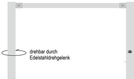
**Feuerverzinkt, schwenkbar mit einem Querholm**
