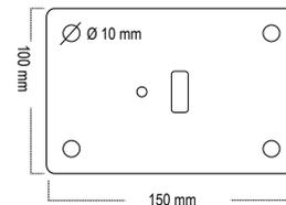
Ankerplatte zum Einbetonieren
