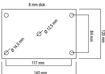
**Ankerplatte zum Einbetonieren**
