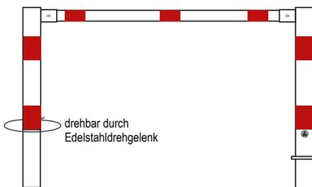
**Feuerverzinkt und weiß lackiert mit roten reflektierenden Folien, schwenkbar mit einem Querholm**
