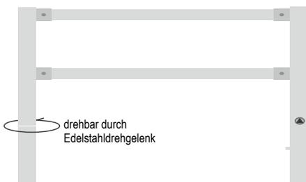
**Feuerverzinkt, schwenkbar mit einem Quer- und Knieholm**
